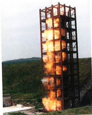
1.30 Explosie in een melkpoederfabriek. Het poeder kan door de grote verdelingsgraad exploderen.
